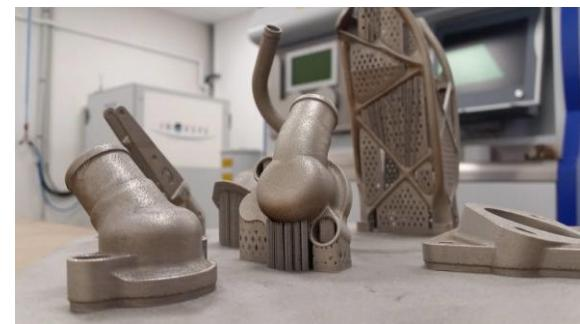
Qualification matériaux/ procédés, définition de la paramétrie d'un nouveau matériau, réalisation de pièces complexes, prototypage... INOVSYS met en œuvre les technologies SLM/DMLS, SLS et FDM hautes températures.
