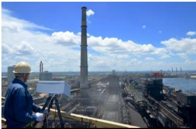
Depuis 2001, ATE et maintenant Paramount Advanced Technologies développent et commercialisent des capteurs hyperspectraux utilisant l'imagerie infrarouge passive pour détecter des nuages de gaz en mesurant l'énergie collectée depuis la scène dans le domaine spectral infrarouge.
