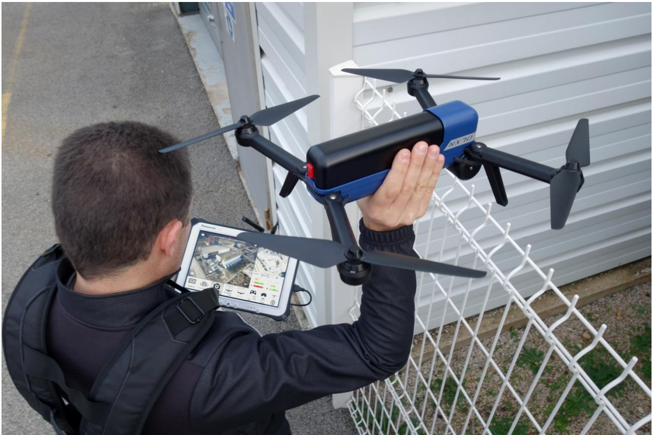
Le drone NX70 de Novadem avec sa station de contrôle
